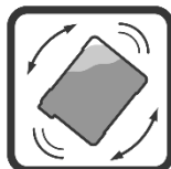
Wstrząśnij kanistrem kilka razy w celu wstępnego połączenia się bazy z aktywatorem
